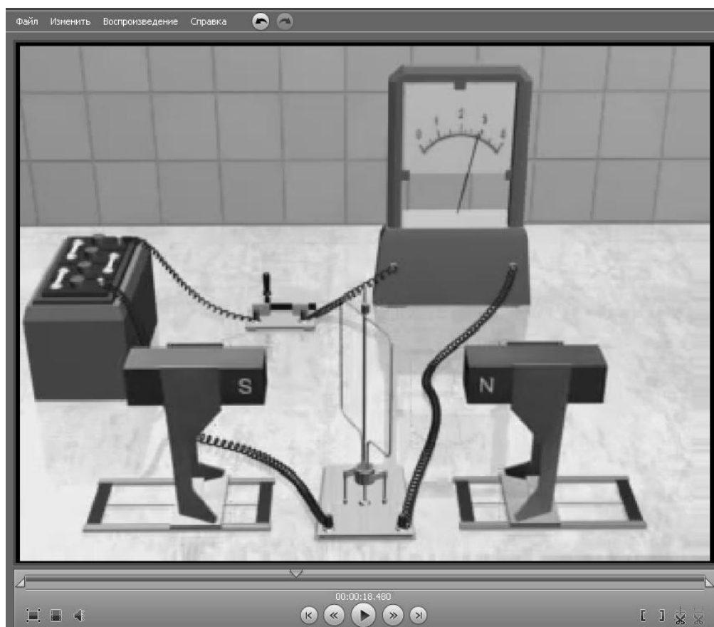
Рис. Е.4. Віртуальна модель лабораторного стану з вивчення роботи електричного двигуна постійного струму
