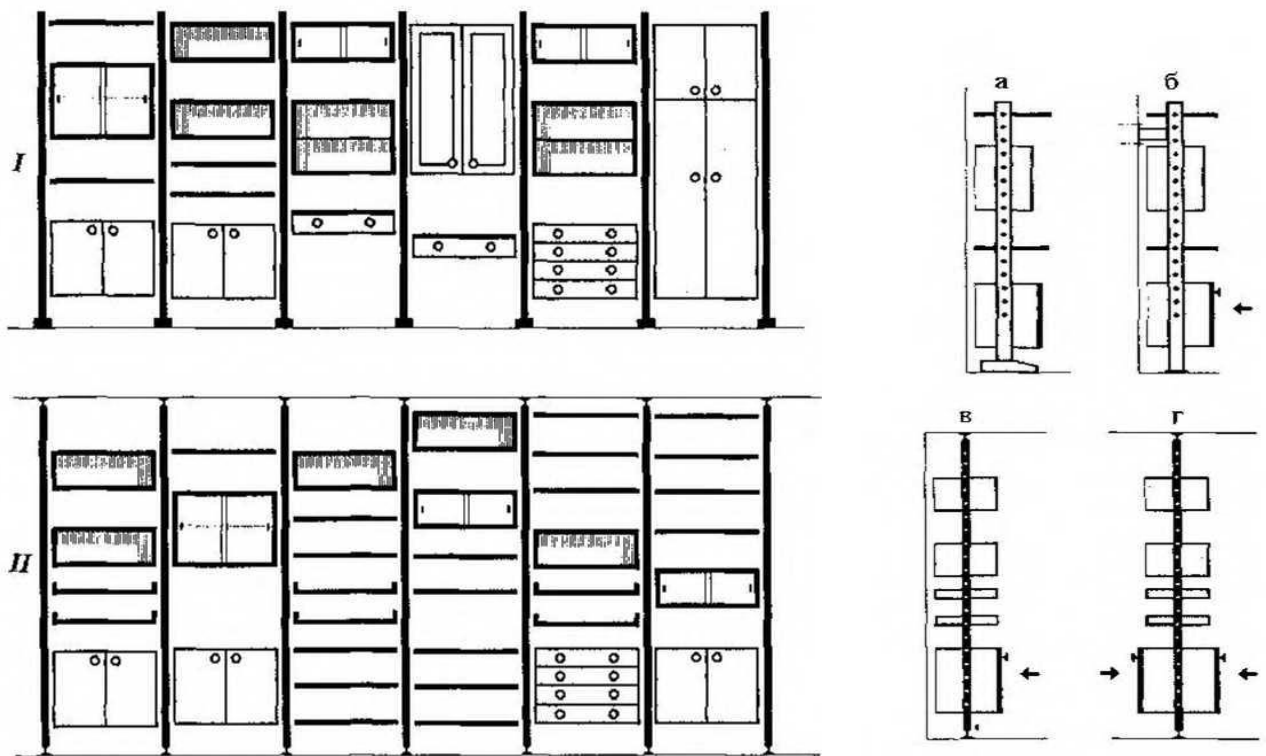
Рис. 2.3. Компонувальноконструктивні ознаки стелажних меблів
