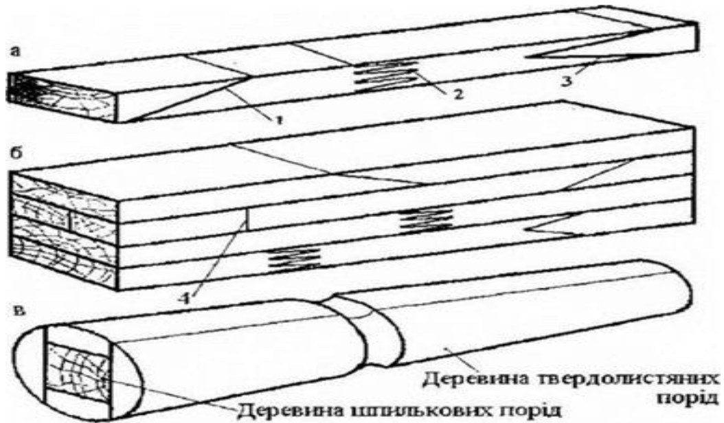
Рис 5.3 Варіанти формування заготовок для переклеїних деталей
