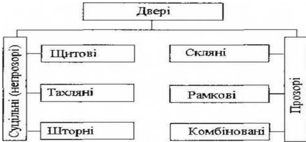
Рис 6.3 Класифікація дверей за конструктивними ознаками
