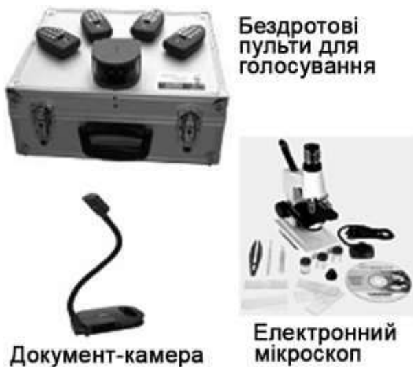
Рис. 3.4. Апаратні засоби, що дозволяють розширити функціональні можливості інтерактивної дошки або інтерактивної панелі
