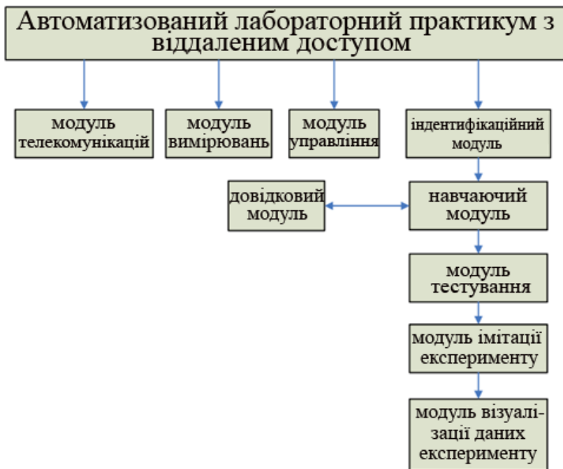
Рис. 9.4. Структура автоматизованого лабораторного практикуму з віддаленим доступом
