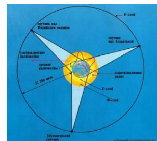
Рис. 10. Схема розміщення супутників на геостационарній орбіті
