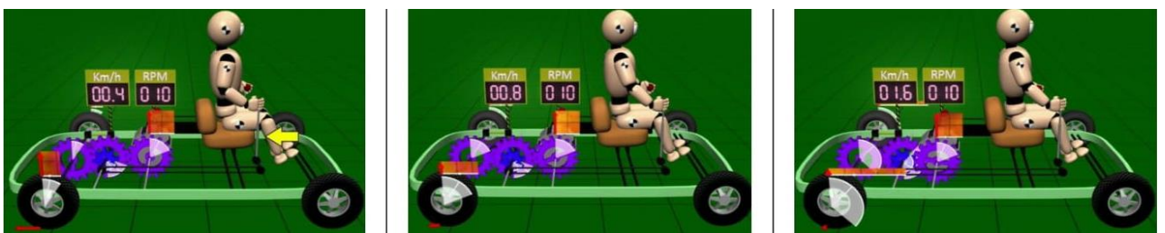
Рис. 2. Візуалізація зміни потужності та шляху пройденого колесами на 1 с у напрямі зліва направо: понижена передача для початку руху (світлі сектори зменшуються від двигуна до ведучих коліс, а потужність розподіляється між ведучими колесами); середня передача (світлі сектори збільшуються, а потужність на ведучих
