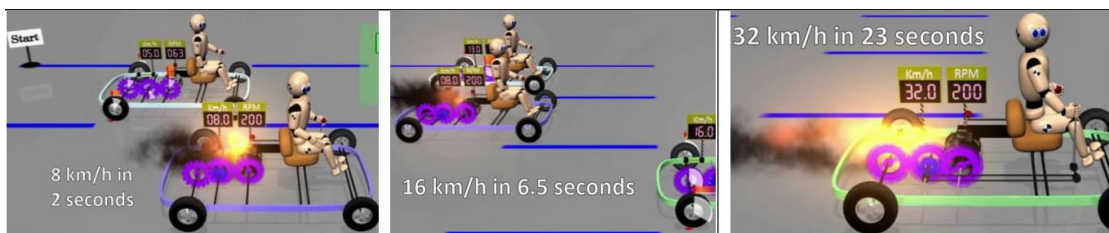
Рис. 5. Візуалізація ситуацій досягнення максимальної частоти обертання вала двигуна у напрямі зліва направо: на пониженій передачі 8км /год за 2 с; на середній передачі 16 км/год за 6,5 с; на підвищеній передачі 32км/год за 23 с
