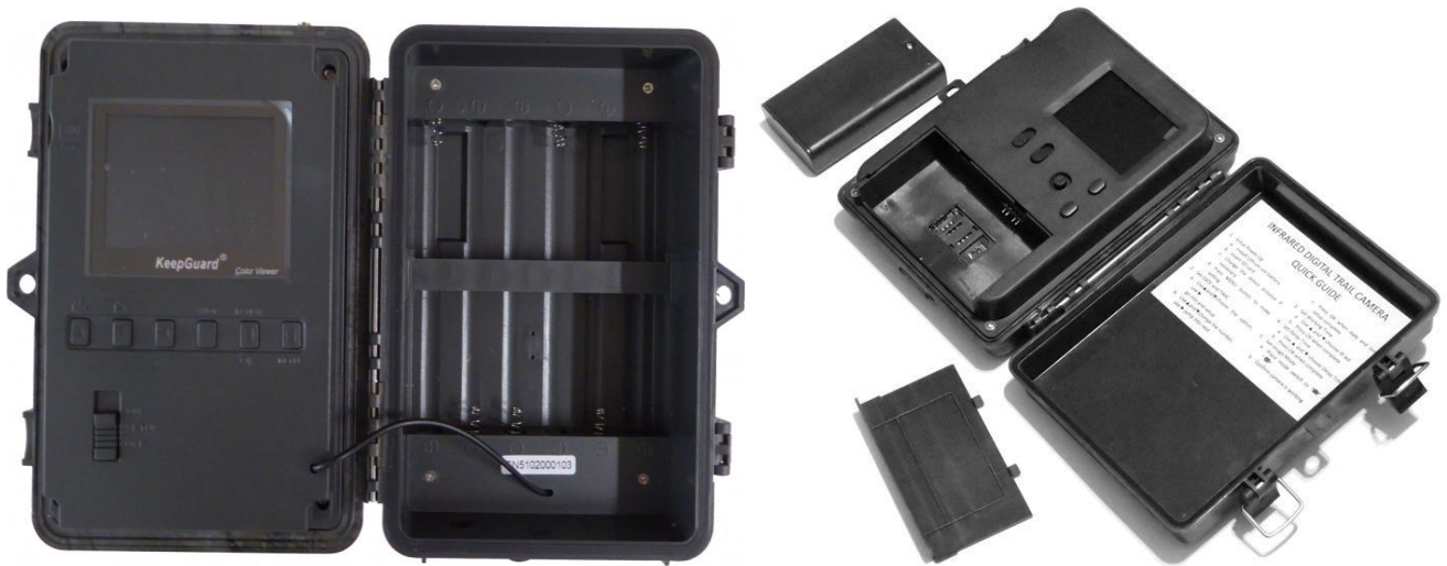
Рис. 3.14. Фотопастки з елементами живлення типу АА та акумулятором
