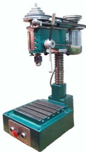
Рис. 1. Загальний вигляд настільного свердлильного верстату моделі 2М112 (зі знятим кожухом клинопасової передачі).
