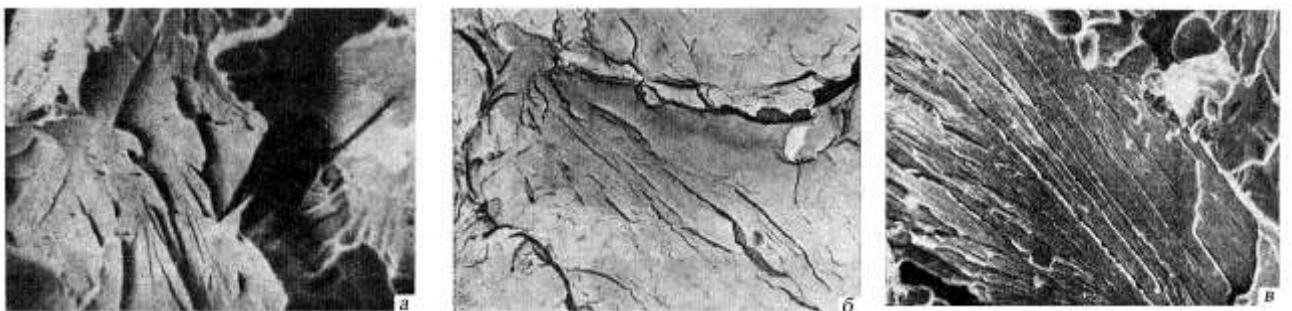
Рис. 2.4. Сходинки, струмкоподібний візерунок: а – сходинки, які є елементами поверхні крихкого або квазікрихкого руйнування. РЕМ. X 800. Утворюються при з'єднанні двох поверхонь руйнування, розміщених на різних рівнях; можуть виникати також в результаті сколу вздовж меж мікродвійників, можуть бути прямолінійної або вигнутої форми; найбільш часто сходинки проявляються при з'єднанні двох фасеток сколу (сходинки сколу). Спостерігаються при внутрішньозеренному крихкому руйнуванні; б, в – струмкоподібний візерунок (б – ПЕМ. X 1500);
