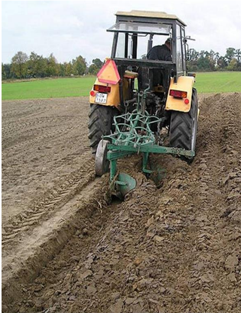
Рис. 5. Борозна, утворена корпусом лемішного плуга (ліворуч скраю)
