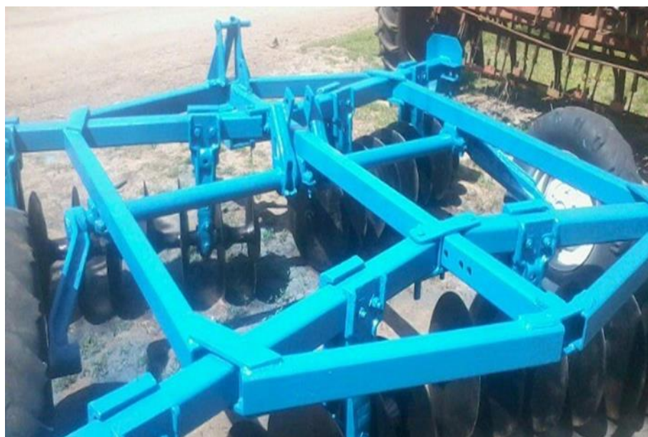
Рис. 4. Механізм підйому борони БГГ-3, укомплектованої сферичними дисками
