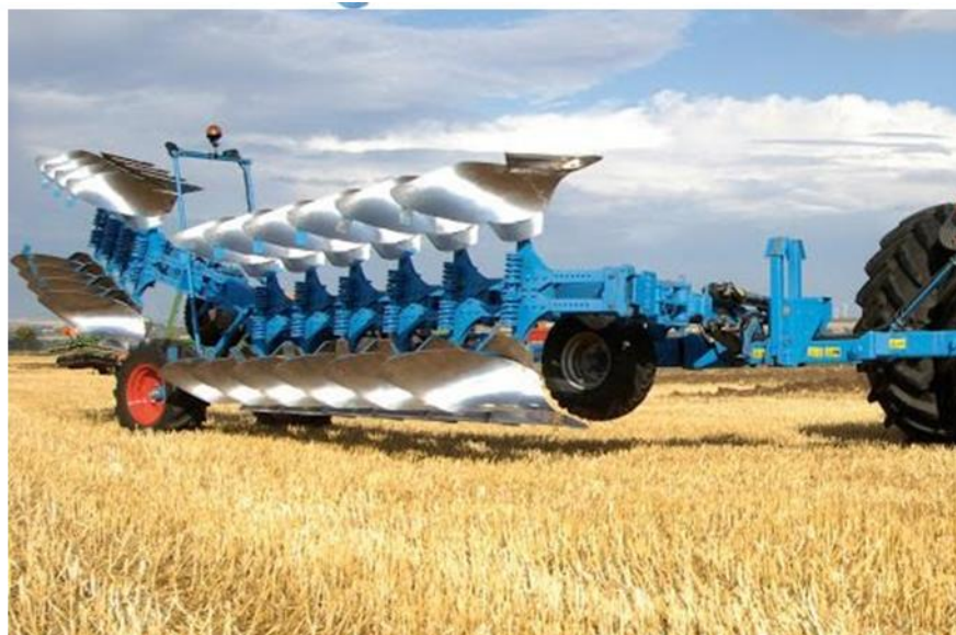
Рис. 13. Оборотний плуг для гладкої оранки
