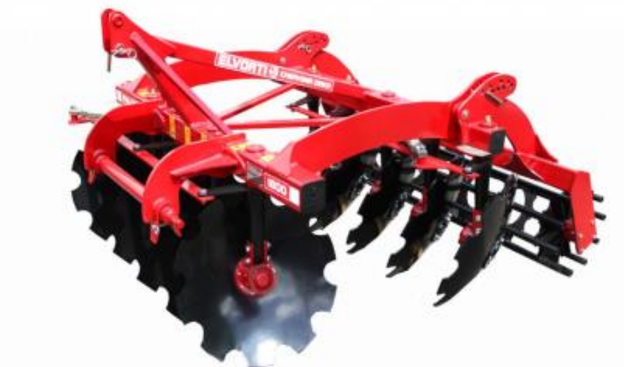
Рис. 6. Борона дискова навісна серії PALLADA (ходові колеса не зображені)
