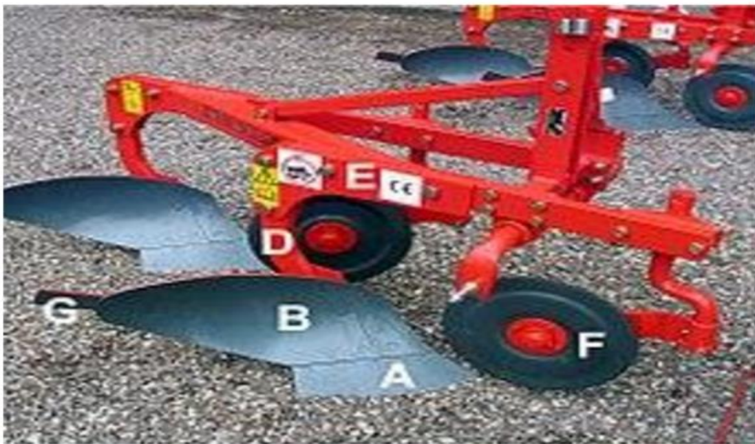
Рис. 4. Сучасний лемішний одно-і двокорпусний плуг:
